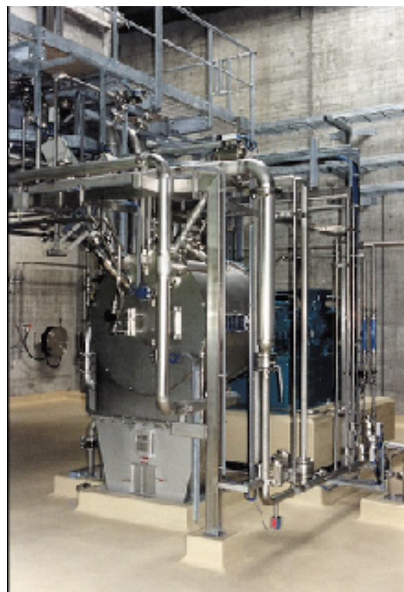
Impianto di disidratazione e alcolizzazione per esplosivi progettato e realizzato dal gruppo BOWAS, di cui fa parte anche DMP. Fonte:
