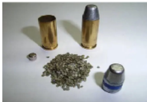
I componenti principali di una moderna cartuccia. Da sx: il detonatore (primer), il bossolo in ottone (sostituito anche da alluminio, acciaio laccato, ottonato o nichelato), la polvere da sparo in scagliette, la punta in piombo indurito.
