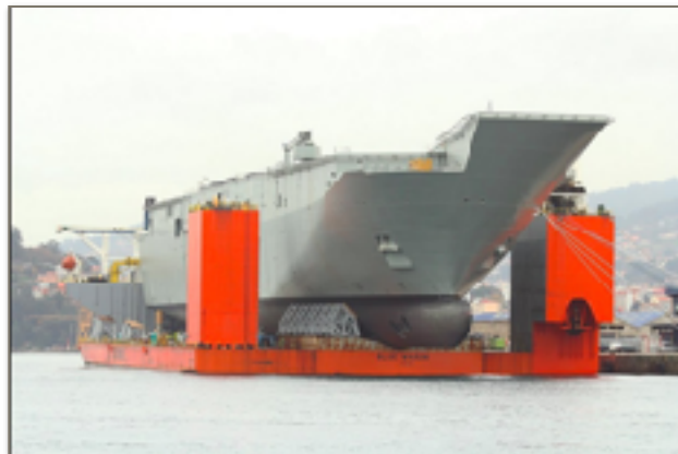
Figura 6: Un trasporto estremo: "Blue Marlin", nave heavy lift semi-sommersibile della società olandese Dockwise, ha caricato nel cantiere Navantia di Ferrol, Spagna, lo scafo della "HMAS Adelaide". Questa nuova portaelicotteri, verrà completata nel cantiere BAE Systems Australia di Victoria, dove giungerà dalla Spagna dopo un viaggio di due mesi.
