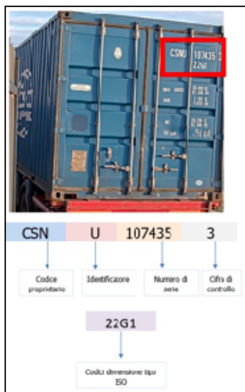
Figura 32: Esempio codifica di container ISO 6346, cioè di inniego generale.
