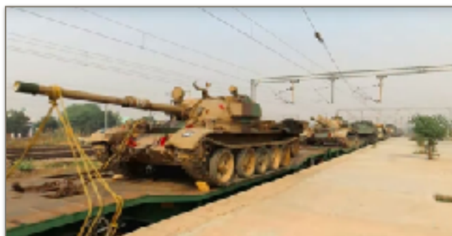
Figura 27: Un treno speciale della NDA National Defence Academy (Accademia militare indiana) transita a Mathura Junction, Uttar Pradesh. Un coppia di motrici diesel traina 26 flatcars con carri armati e scivoli di carico, camion, blindati e veicoli leggeri, 4 vagoni passeggeri attrezzati a cucine e servizi, 6 vagoni merci.
