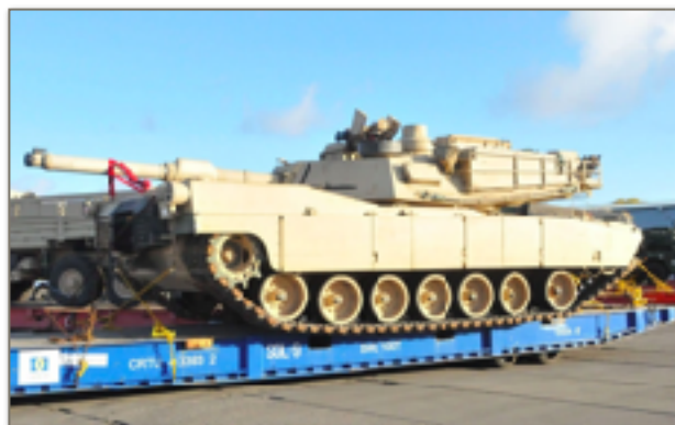
Figura 3: Carro armato M1A2 SEPv3 caricato su un trailer Mafi, noleggiato dalla società Saeco.
