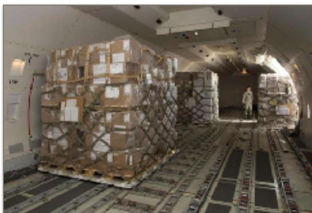
Figura 35: Pallet cargo sono caricati su un Boeing 747 della Kalitta Air alla Dover Air Force Base, Delaware. Sono visibili le documentazioni sui singoli colli e il "manifesto di pallet" sull'imbrago.
