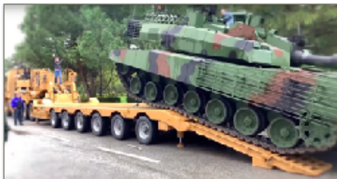
Figura 4: Un camion BMC Tugra 8x8, di fabbricazione turca, trasporta un carro armato pesante BMC Altay con un trailer a 6 assi.
