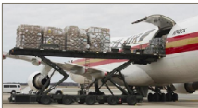
Figura 23: Air cargo pallet vengono caricati attraverso la porta laterale principale su un Boeing 747 di Kalitta Air nella US Air Force Base di Dover, Delaware.
