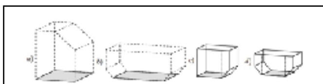
Figura 22: Esempi di pallet a) per il ponte principale b) per il ponte inferiore. Esempi di container per il ponte inferiore c) mezzo standard di aerei widebody d) completo per narrowbody
