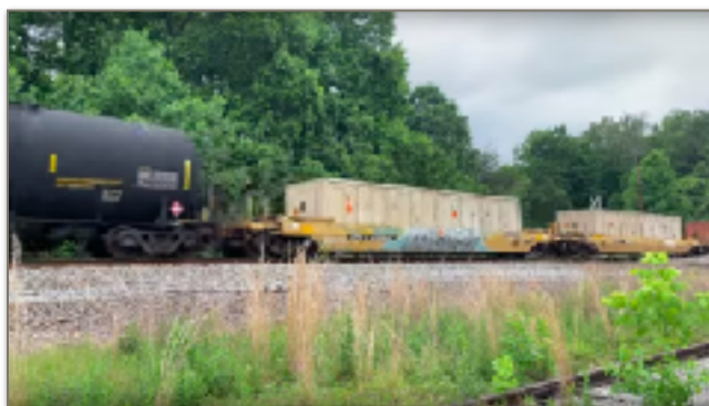
Figura 28: Un tren de carga CSX en "Clinchfield Road" con cargas militares con destino al puerto de Wilmington, Carolina del Norte. Tenga en cuenta las etiquetas naranjas y la aparente falta de segregación entre inflamables y explosivos
