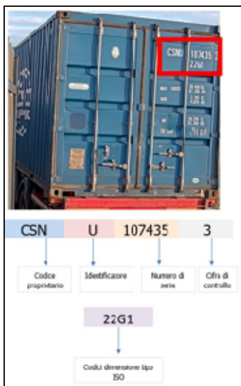
Figura 32: Ejemplo de codificación de contenedores ISO 6346, es decir, de uso general.
