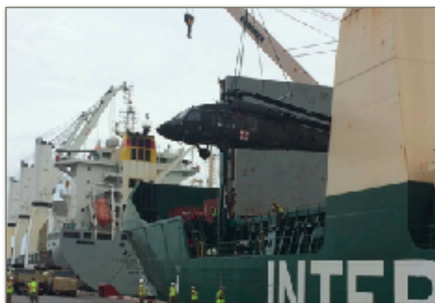
Figura 19: El programa MSP tiene una dimensión global. Aquí un helicóptero UH-60 "Black Hawk" se descargó en el puerto de Sattahip, Tailandia, desde el barco "Ocean Grand", un transporte pesado de propósito general de Intermarine en fletamento para el Comando de Transporte Marítimo Militar de los Estados Unidos, que partió de la base conjunta en Tacoma, Washington, para apoyar cuatro meses de maniobras militares en el área del Pacífico.
